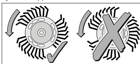
Montera taggbrickan (11) och skruven (12) samt dra åt med insexkantnyckeln (13).
